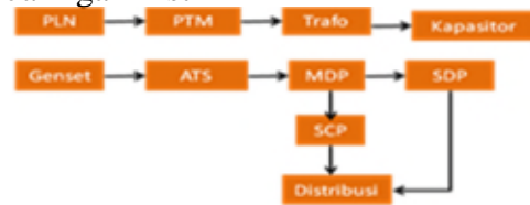
Gambar 32. Sistem Jaringan Listrik
