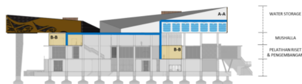
Gambar 7; Distribusi Air Bersih ke Lantai 3 & 2
