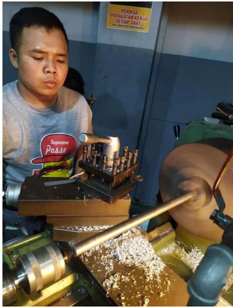
Proses pembubutan ass poros
