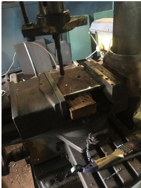
Proses pengeboran untuk penempatan poros gear reverse
