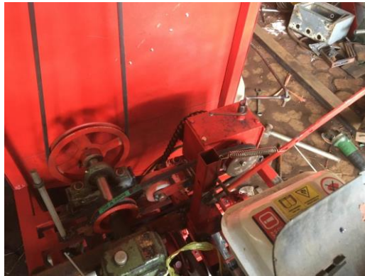
Pemasangan gearbox komplek
