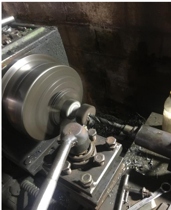
Pembubutan dan pengeboran bushing untuk gear reverse
