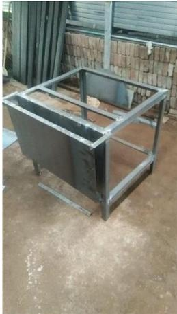
Gambar 7 proses pengelasan rangka
