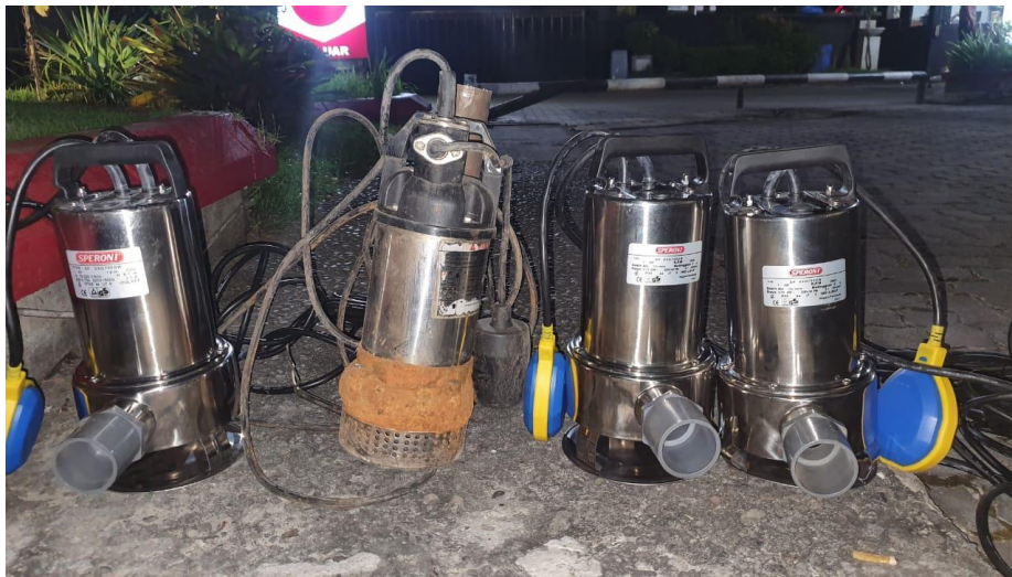
Gambar untuk selenoid dan pompa 1 fasa untuk air mancur
