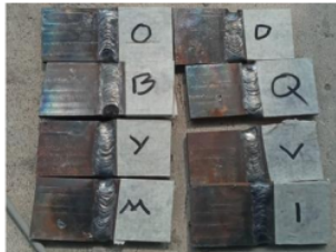
Gambar 3.3 Material setelah di las
