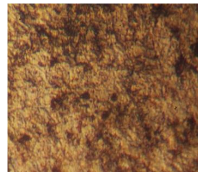
Gambar 4.3 Struktur Pada Logam Las
