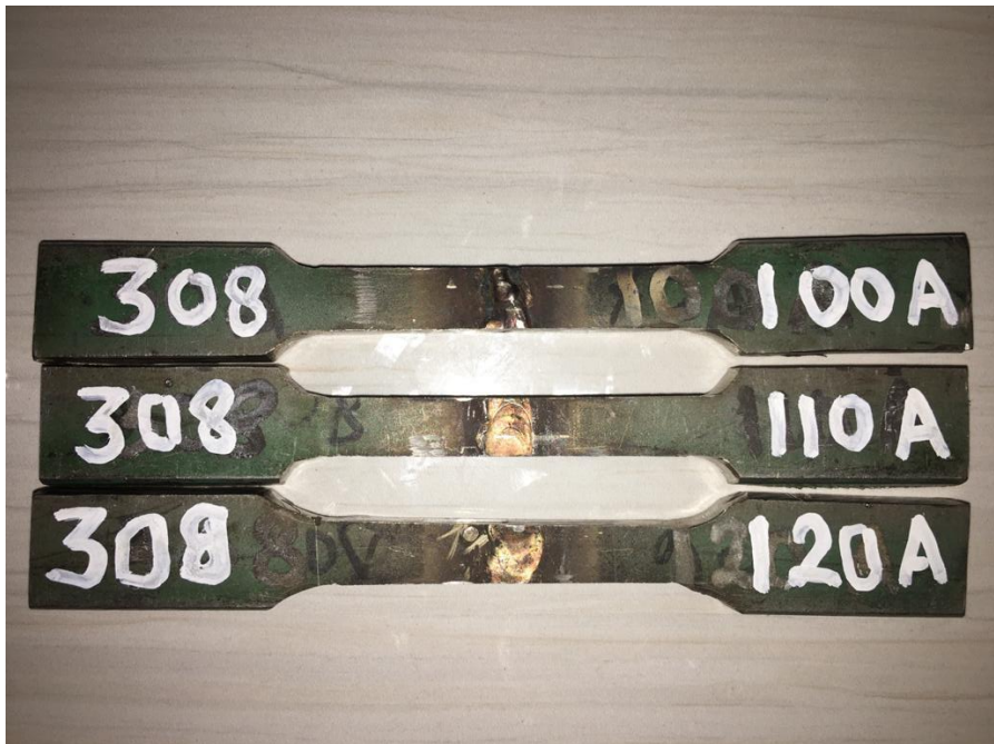
Bentuk Spesimen Uji Tarik untuk welding elektroda 308
