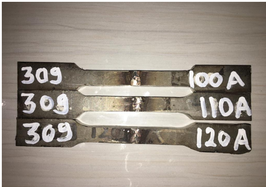
Bentuk Spesimen Uji Tarik untuk welding elektroda 309
