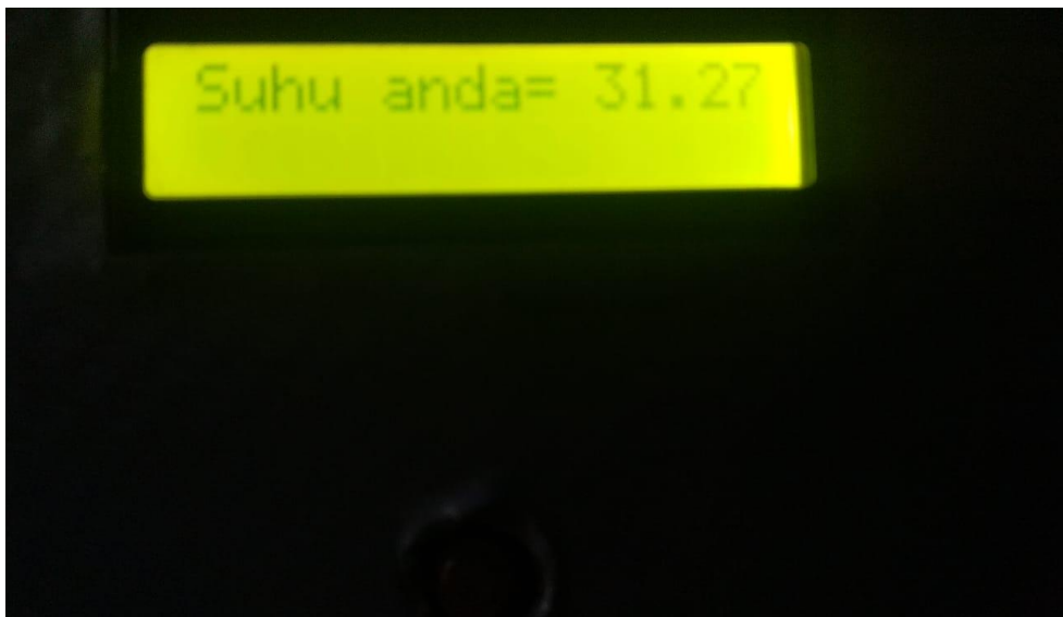
Gambar 4.20 Sensor GY-MLX membaca suhu tubuh
