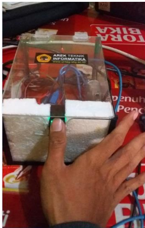
Gambar 4.18 Pengujian Pendaftaran Sidik Jari jempol
