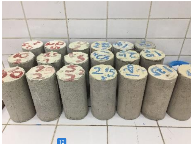
12 Gambar 2 Benda Uji Untuk Pengujian Kuat Tekan
