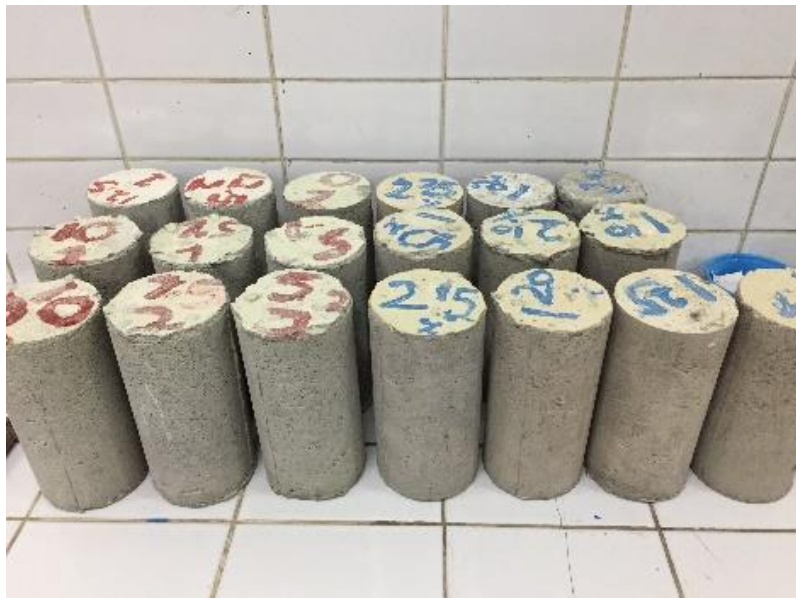
Gambar 2 Benda Uji Untuk Pengujian Kuat Tekan
