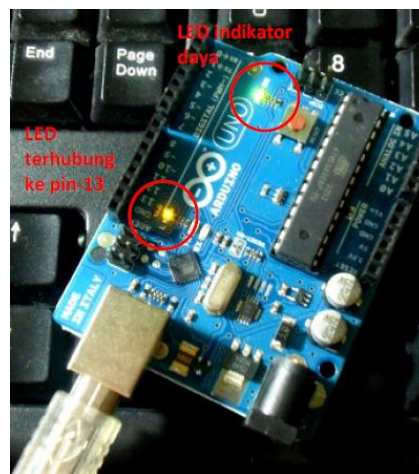
Gambar 2.20 Uji coba Arduino melalui parameter lampu LED
