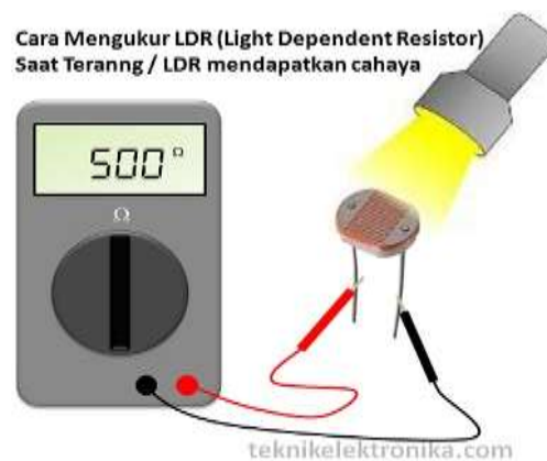
Gambar 2.2 Pengukuran LDR kondisi terang
