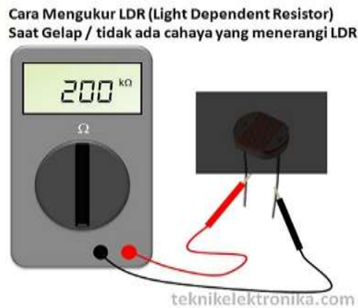
Gambar 2.3 Pengukuran LDR kondisi gelap
