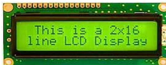
**Gambar 2.7** LCD 16x2
