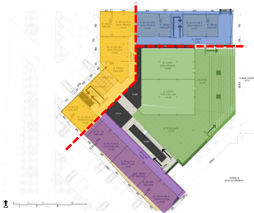
Gambar 42; Dilatasi Struktur Bangunan Sumber; Desain Pribadi
