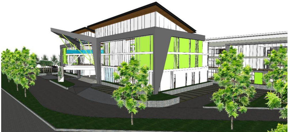
Gambar 26; ‘Teritisan’ untuk menangkis cahaya matahari langsung Sumber: Desain Pribadi
