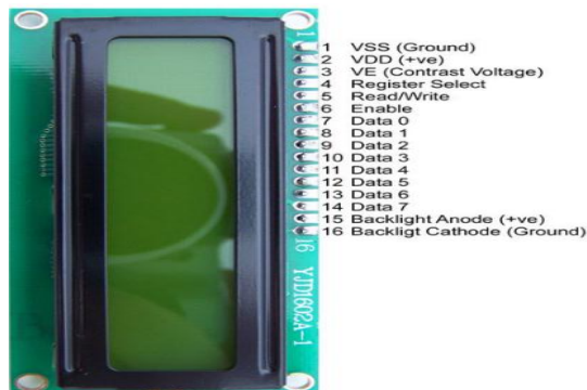
Gambar 2.6 Bentuk fisik dan konfigurasi LCD 2 x 16
