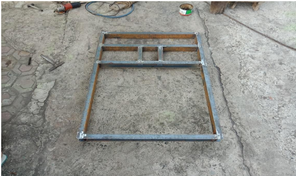
Gambar rangkai bawah berfungsi sebagai kaki pada katrol manual yang akan diberi pemberat keseimbangan ketika katrol membawa beban.
