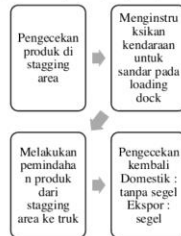
Gambar 2 Alur Proses Aktivitas Loading Unloading
