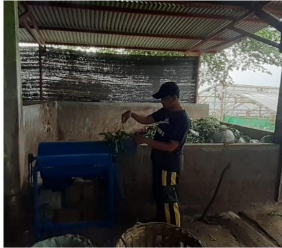
Gambar 0.6 Alat pencacah limbah organik saat pengujian
