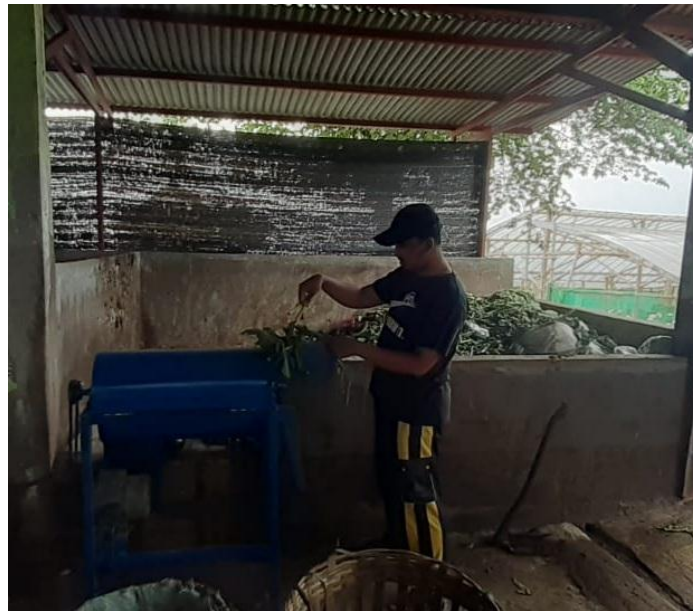
Gambar 0.6 Alat pencacah limbah organik saat pengujian
