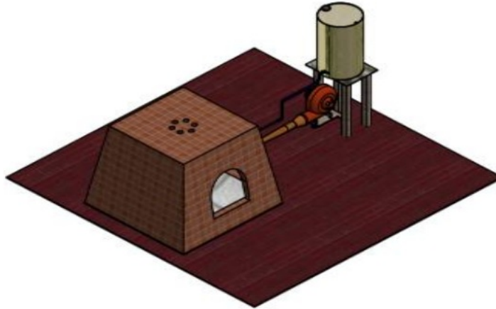
Gambar 5. Design Tungku Bahan Bakar Oli bekas Gambar 5.1 Hasil Perancangan Tungku
