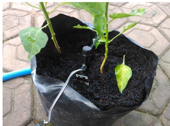
Gambar 6. Pengujian Sensor Kelembapan Tanah
