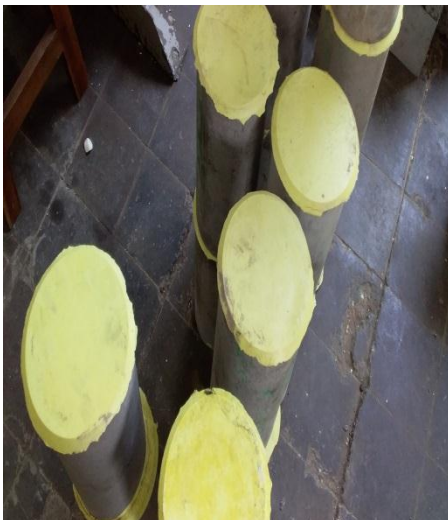
➤ Keeping (meratakan atas atau bawah beton ) dengan belerang
