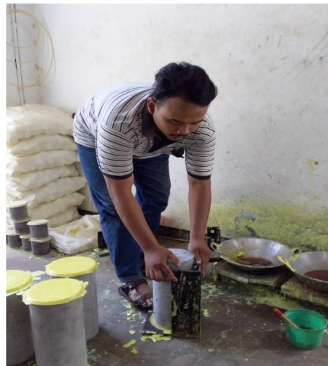
➤ Keeping (meratakan atas atau bawah beton ) dengan belerang
