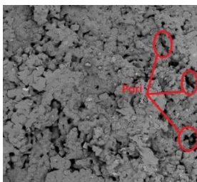
Gambar 9. Hasil Pengujian SEM mesh 300-350 beban penekanan 35\text{kg/cm}^2 perbesaran 50x.
