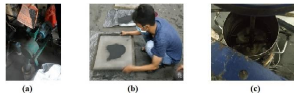
Gambar 1. (a) Proses menghancurkan abu dasar batu bara. (b) Proses penyaringan abu dasar batu bara. (c) Proses Pencucian abu dasar batu bara
