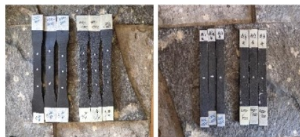
Gambar Spesimen Uji Tarik Dan Uji Bending
