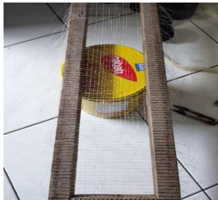
Gambar Proses Penganyaman Serat Sisal dengan Arah Sudut 0^\circ , 90^\circ , 22^\circ
