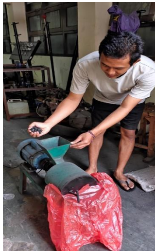
Gambar Penghancuran Bongkahan Abu Dasar Batubara dengan Mesin Crusher
