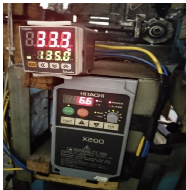
Gambar Mesin Roll dan Pengatur Kecepatan Roll
