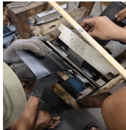
Gambar Hasil Lembaran Laminat dengan Campuran Abu Dasar Batubara dan Serat Sisal
