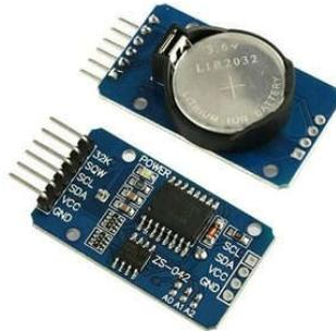
*Gambar 2.8.1 RTC DS3231 Module*
