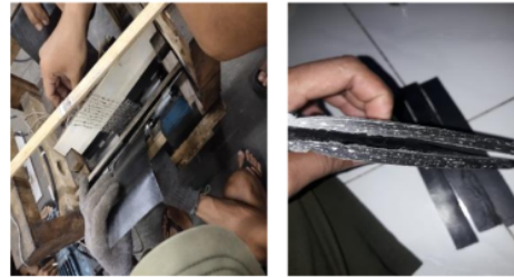
Gambar 1. Proses pembuatan lembar laminat dan Lembar laminat dengan variasi serat
