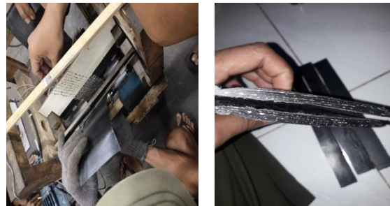
Gambar 1. Proses pembuatan lembar laminat dan Lembar laminat dengan variasi serat
