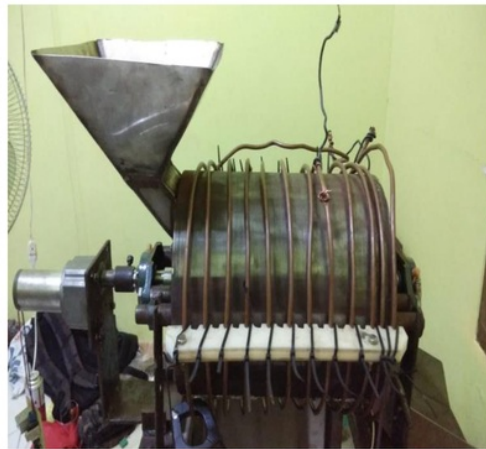
Gambar 3. Alat mesin sangrai kopi pemanas induksi
