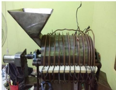
Gambar 3. Alat mesin sangrai kopi pemanas induksi
