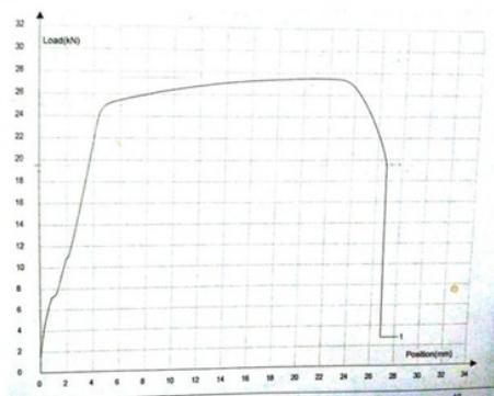
Gambar 5. Grafik uji tarik spesimen 10 mm
