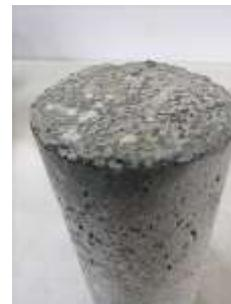
Gambar 8. Analisa Secara Fisik Mortar Curing Air Laut
