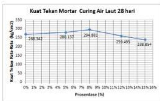
Gambar 7. Analisa Kuat Tekan Mortar Curing Air Laut Umur 28 hari
