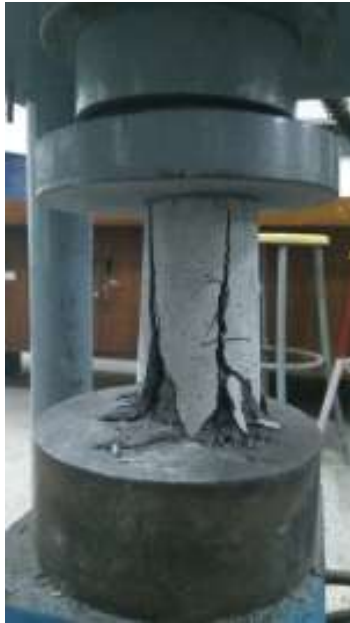
Pola Retak Yang Terdapat Pada Benda Uji.
