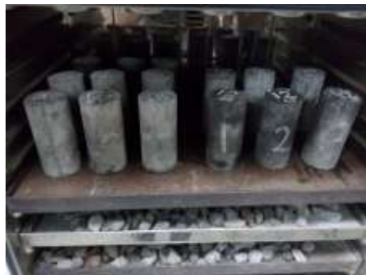
Tes Resapan Mortar Yang Dimasukkan Ke Dalam Oven
