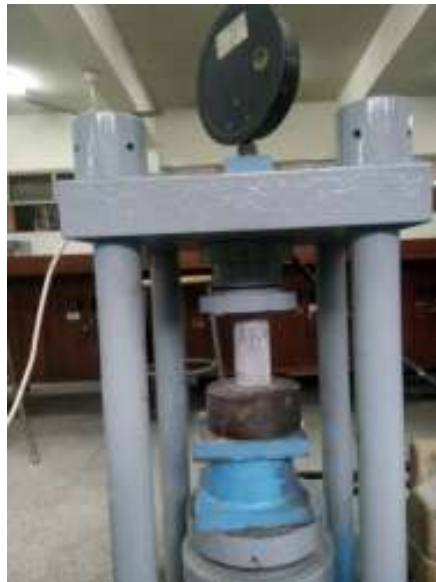
Uji Tes Tekan Pada Benda Uji
