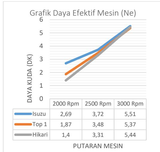
Gambar 6. Grafik daya efektif mesin ( $N_e$ )
