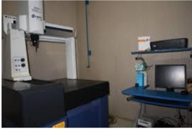
Gambar 3. Alat Ukur CMM
