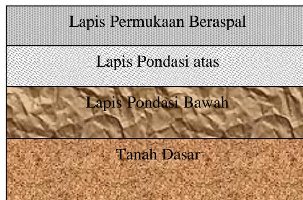
Gambar 2.1. Tipikal Konstruksi Perkerasan Lentur
