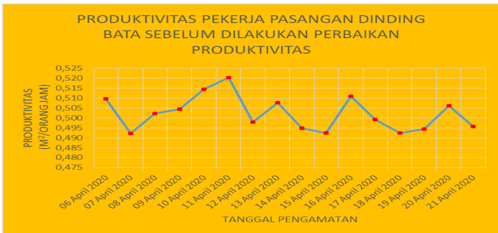
Gambar 4.4 Produktivitas Pekerjaan Pasangan Dinding Bata Sebelum Dilakukan Perbaikan Produktivitas
