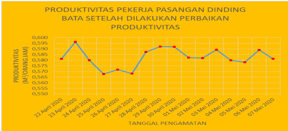
Gambar 4.5 Produktivitas Pekerjaan Pasangan Dinding Bata Setelah Dilakukan Perbaikan Produktivitas
