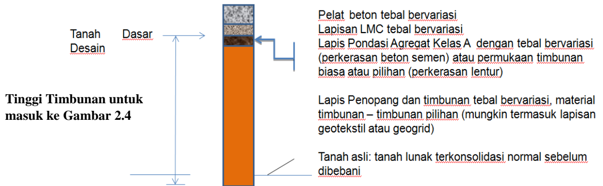
Gambar 2.6 Struktur Perkerasan Kaku yang Digunakan Dalam Analisa
