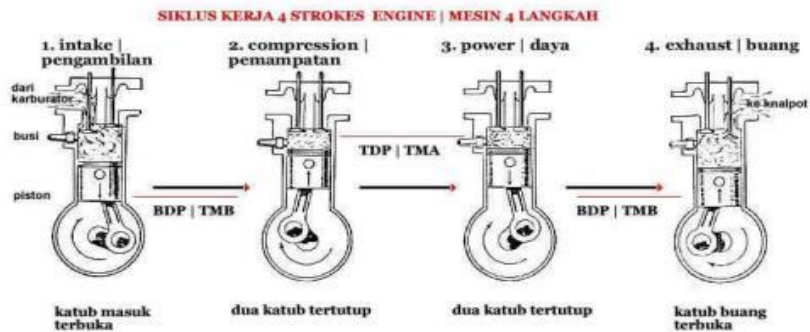
Gambar 2.1. Siklus kerja mesin 4 langkah
