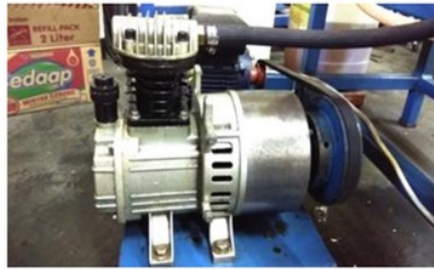
Gambar 5 Kompresor yang telah di modifikasi
