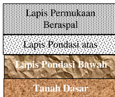
Gambar 2.1. Tipikal Konstruksi Perkerasan Lentur
