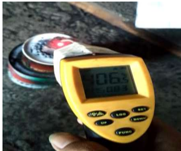
Mengukur Temperatur Menggunakan Termometer Infra Merah
