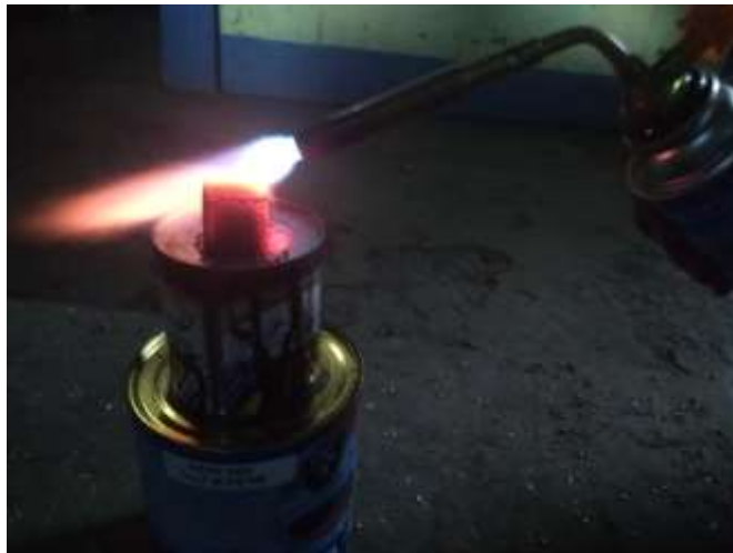
Menyalakan Atau Pembakaran Briket Dengan Menggunakan Pemanas Portable
