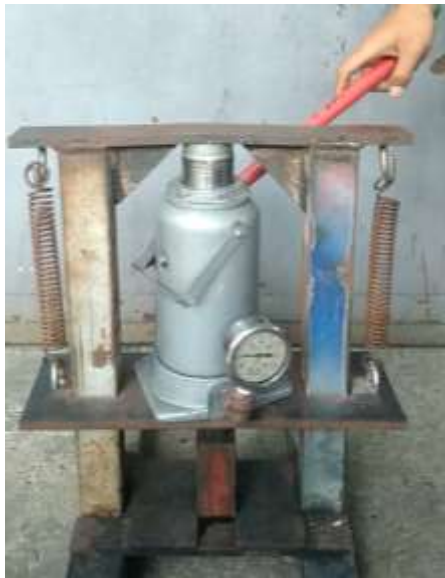
Proses Pengepresan Briket
