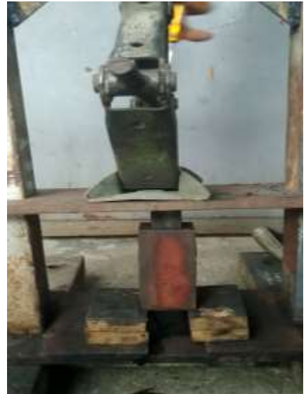
Proses Pengambilan Briket Yang Melalui Proses Pengepresan
