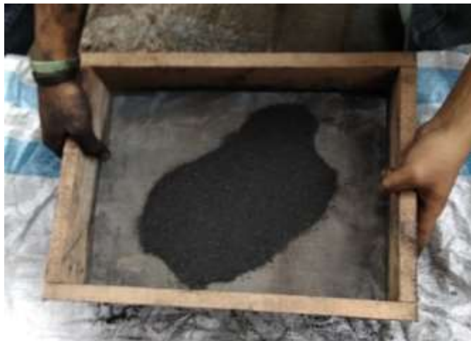
Proses Pengayakan Bahan Briket Dengan Mesh 60
