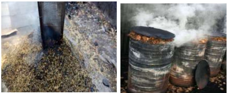
Gambar 3.5 Proses Pembakaran (Karbonasi)
