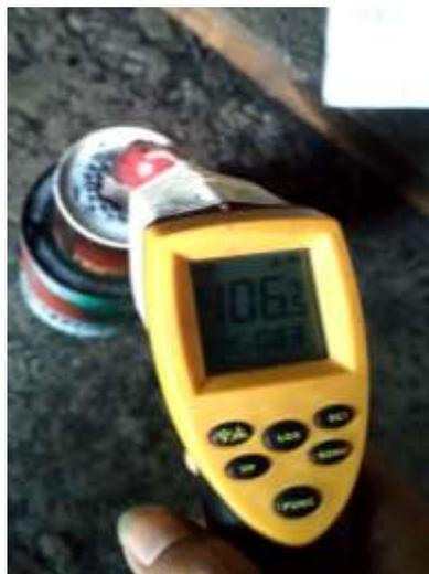
Mengukur Temperatur Menggunakan Termometer Infra Merah
