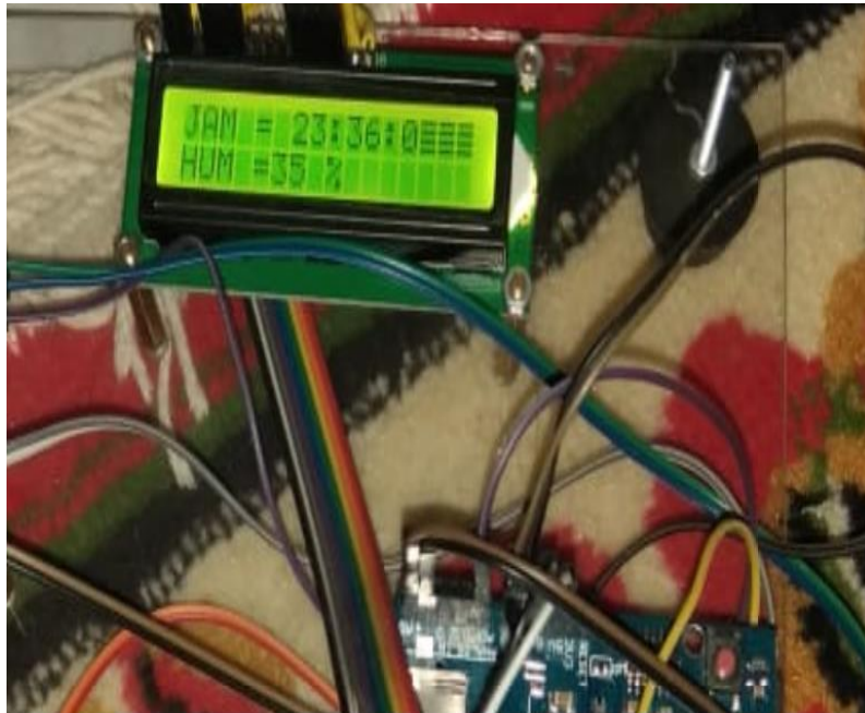
Gambar 4.11 Uji alat Code Monitor Kelembapan Tanah
