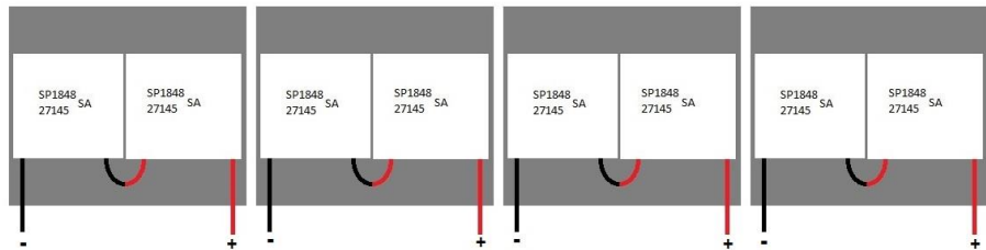
Gambar 2.5 Termoelektrik disusun secara seri
