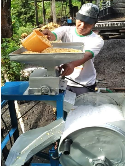
Gambar 2. Proses pengupasan kedelai menggunakan alat
