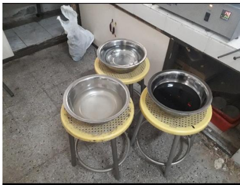
Media Quenching Air mineral, Oli dan larutan garam dengan volume masing masing 1500 ml
