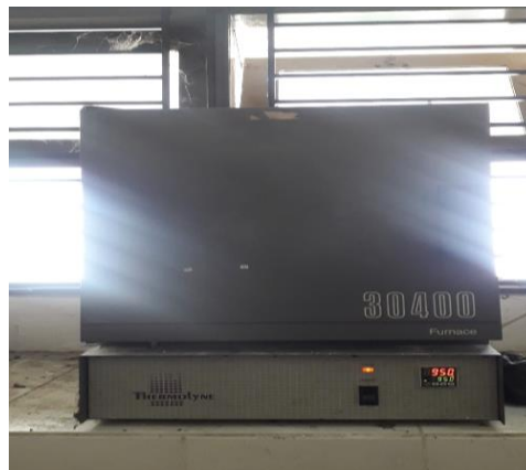
Alat untuk proses Heattreatment (Furnace)
