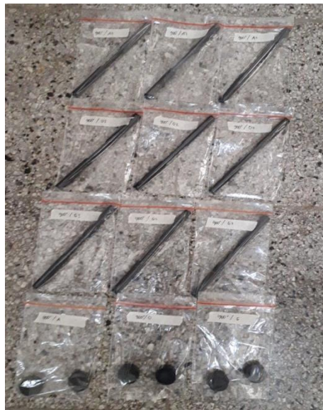
Kodefikasi Spesimen Uji tarik Dan kekerasan setelah Proses Heattreatment 900°C Dengan Quenching Air mineral,Oli dan larutan Garam
