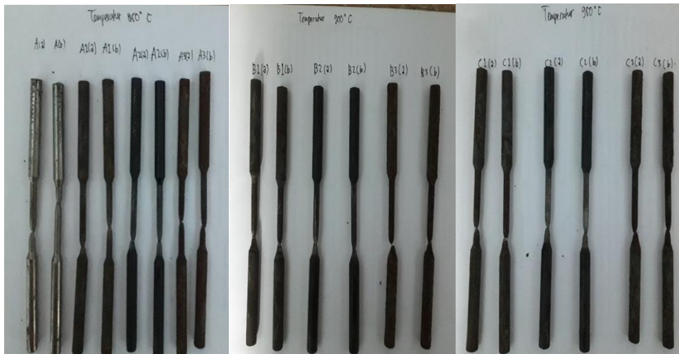
Spesimen Setelah Uji Tarik dengan Heattreatment Temperatur 850°C,900°C dan 950°C dengan Quenching media Air mineral,Oli dan Larutan garam.
