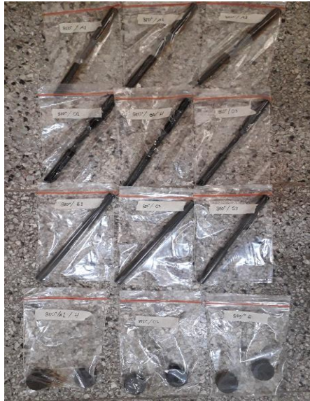
Kodefikasi Spesimen Uji tarik Dan kekerasan setelah Proses Heattreatment 850°C Dengan Quenching Air mineral,Oli dan larutan Garam
