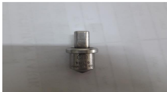
Indentor Uji kekerasan Rockwell dengan Diamond cone (Black)
