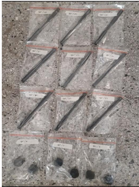
Kodefikasi Spesimen Uji tarik dan kekerasan setelah Proses Heattreatment 950 0 C Dengan Quenching Air mineral,Oli dan larutan Garam.
